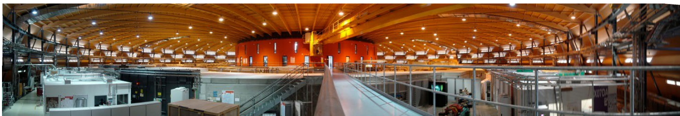
Panoramafoto van de Swiss Light Source, met in het midden de betonnen tunnel die de elektronenbundel herbergt. Links een eindstation, waar experimenten plaatsvinden met de röntgenstraling die wordt opgewekt door de elektronenbundel magnetisch van richting te laten veranderen. (Foto: Wikipedia, David Haberthür)
